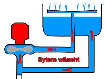
Die selbstentleerende Waschpumpe sorgt für eine vollständige Entleerung des Systems - für noch sichere Hygiene.
