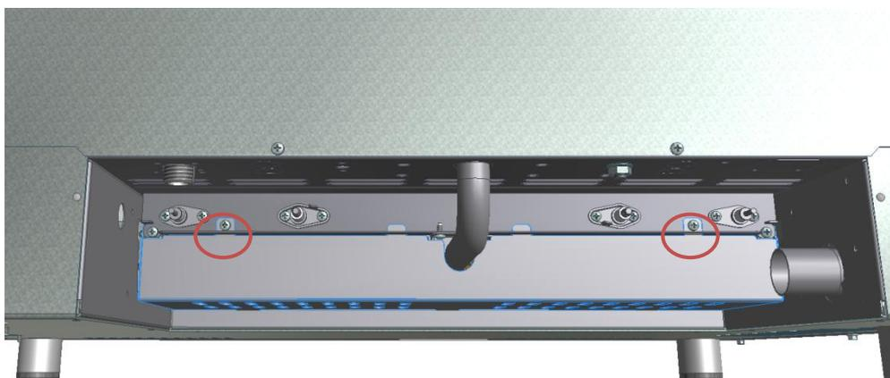
B- entfernen Sie die untere Platte des Brenners
