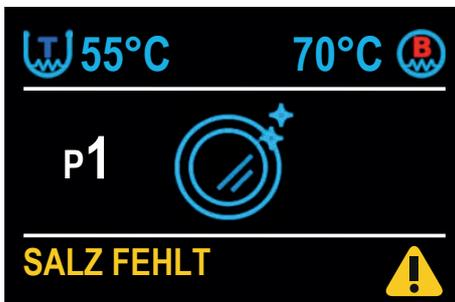
Um Salz nachzufüllen öffnen Sie die Maschinentür, und drehen den Salzbehälterdeckel im Tank auf. Verwenden Sie grobkörniges Regeneriersalz (1-4 mm) und achten Sie darauf, dass es nicht im Tank zerstreut wird. Eine hohe Salzkonzentration würde den ordnungsgemäßen Betrieb der Maschine beeinträchtigen, und zur Stahlkorrosion führen. Nach der Auffüllung den Stöpsel wieder festdrehen.
